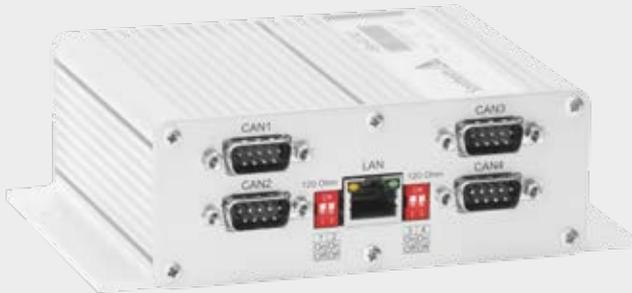
eSys-IDC4E1 ermöglicht die Verbindung verschiedener CAN Busse über IP-Netzwerke. Dafür stellt das performante CAN-to-Ethernet Gateway einen LAN Anschluss und vier galvanisch getrennte CAN Schnittstellen zur Verfügung. Zudem ermöglicht das Modul verschiedenste Mess- und Diagnosefunktionen in Maschinen-Felbussystemen.
