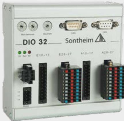
Das DIO32 aus dem Portfolio der Digitalen Remote IO-Module ist ein digitales 24 V bzw. 12 V Ein- und Ausgabemodul mit jeweils 16 Ein- und Ausgängen für den Einsatz in CAN Netzwerken. Mit seinen äußerst kurzen Wartezeiten bei der Signalverarbeitung sowie durch die hohe Prozesssicherheit ist das Modul bestens für den Dauerbetrieb in komplexen Maschinennetzwerken geeignet.
