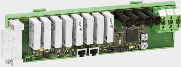
Das Relaismodul ermöglicht die Ansteuerung von bis zu acht Heizpatronen mit 400 V. Es ist in der für die Light-Familie typischen offenen Bauform ausgeführt und besticht durch sein sehr gutes Preis-Leistungs-verhältnis. Mit seinen äußerst kurzen Wandlungszeiten bei der Signalverarbeitung sowie durch die hohe Prozesssicherheit ist auch dieses Modul bestens für den Dauerbetrieb in komplexen Maschinen-netzwerken geeignet.
