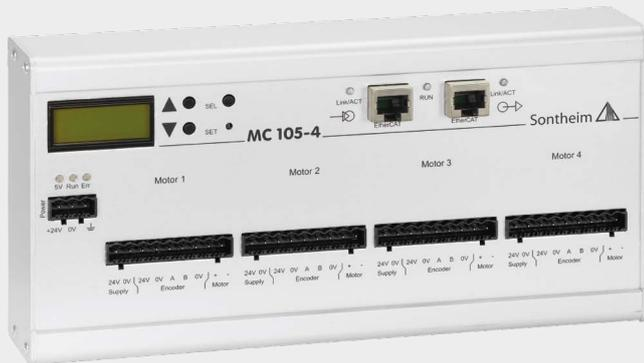
Die MC105 ist eine Antriebssteuerung für bis zu vier DC-Motoren. Sie besitzt diverse Konfigurationsmöglichkeiten und Sicherheitsfunktionen für einen äußerst hohen Bedienkomfort. Die eigene Logik ermöglicht das Konfigurieren und Speichern von Betriebsdaten. Alle angesteuerten Maschinen sind stromgeregelt, dabei können 24 V DC Motoren bis 5 A angesteuert werden. Jedem Motor steht ein Inkrementalgeberingang mit einer Auflösung von 12 Bit zur Verfügung.
